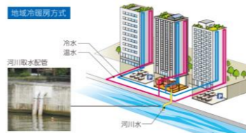
河川水を利用した地域冷暖房システム
